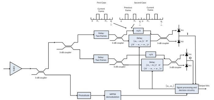
Fig. 3: Receiver of the hybrid DQPSK-MPPM technique adopting DQPSK optical delay detection.
