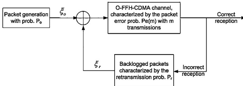
Fig. 1. Optical S-ALOHA/OFFH-CDMA system model.
